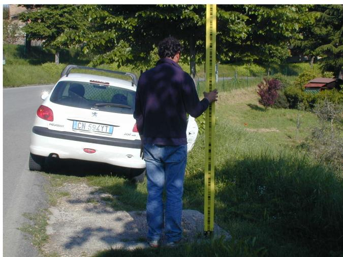
Centrino orizzontale infisso sulla sommità del telaio in calcestruzzo del pozzetto Telecom al Km. 75 + 820 della S.R. 71, sul lato destro in direzione Orvieto.
