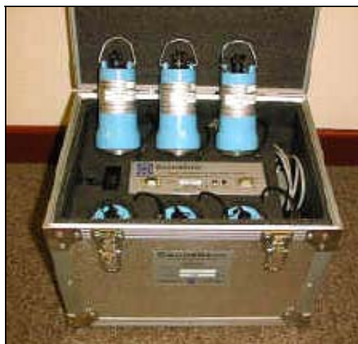
Fig. 124 - Registratori di rumore per l'individuazione delle perdite in rete
