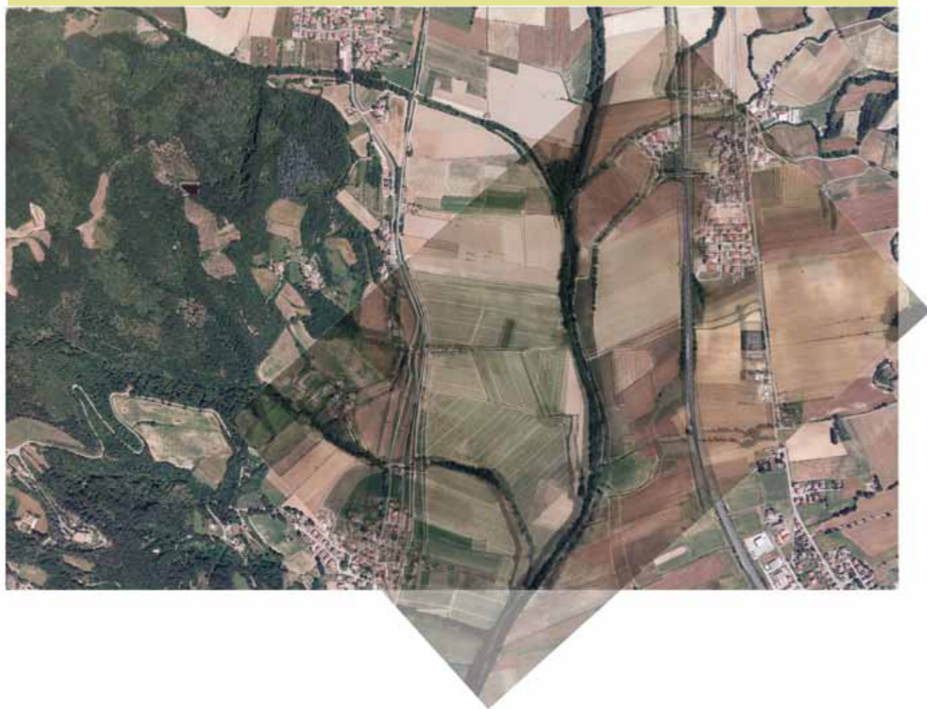
Sovrapposizione di un fotogramma GSD = 18 cm e GSD = 12 cm nel tratto di Fiume Tevere fra le località di San Secondo e Trestina nel Comune di Umbertide.
